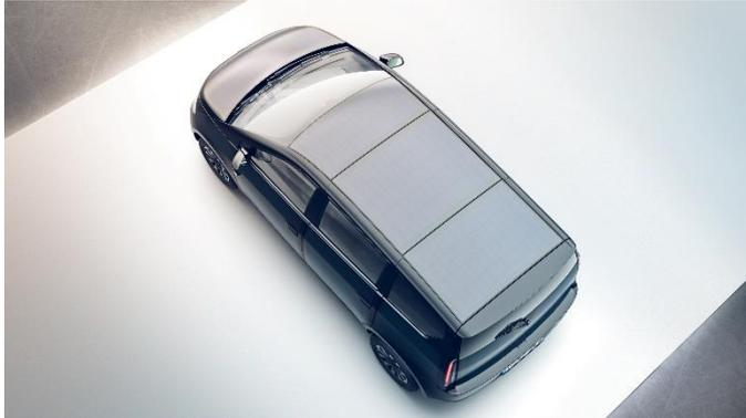
Abb. 23 Oben: Umfassende PV-Integration im Modell Sion (© Sono Motors).
